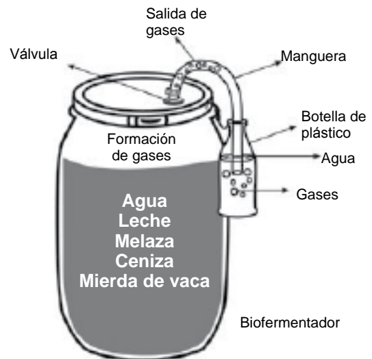
Recipiente con el biopreparado fermentando (observar burbujas de gas en la botella)
