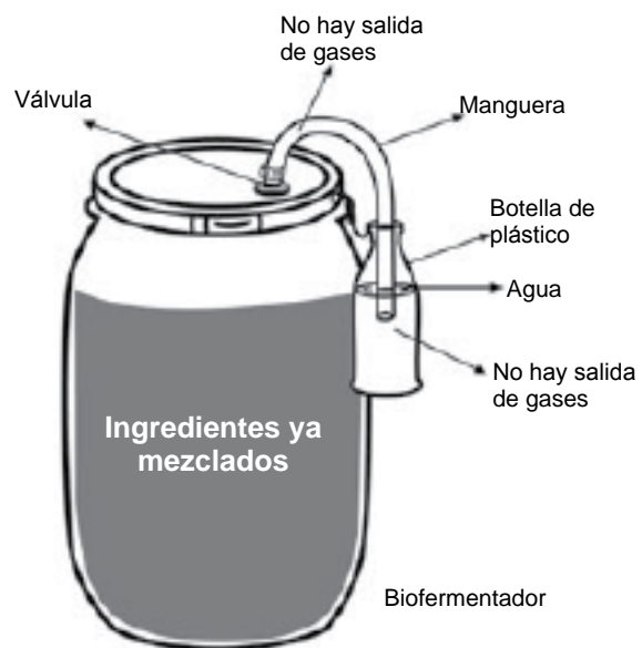
Recipiente con el biopreparado listo para usar después de 30 a 90 días de haber fermentado (observar salida de gases paralizada)
